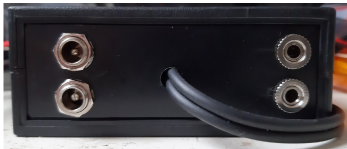
Achterzijde van het kastje, met doorlusmogelijkheid voor de voeding
