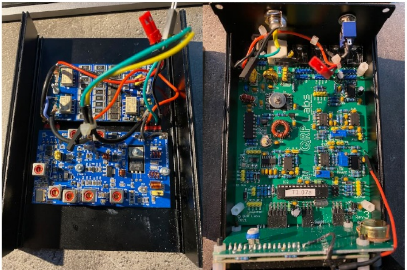
Transverter in deksel en aanpassingen QCX
