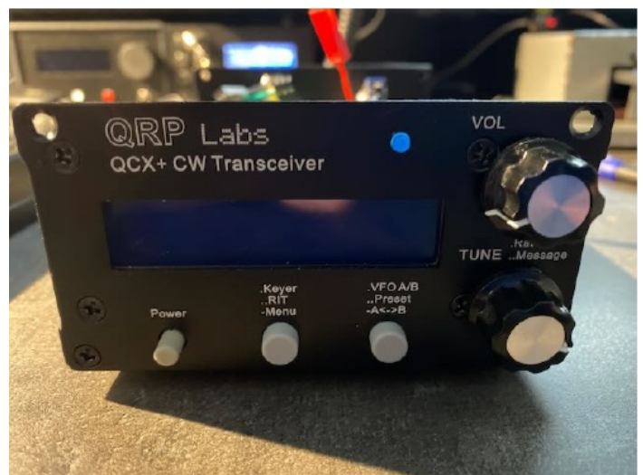
Frontje met extra LED indicatie transverter
