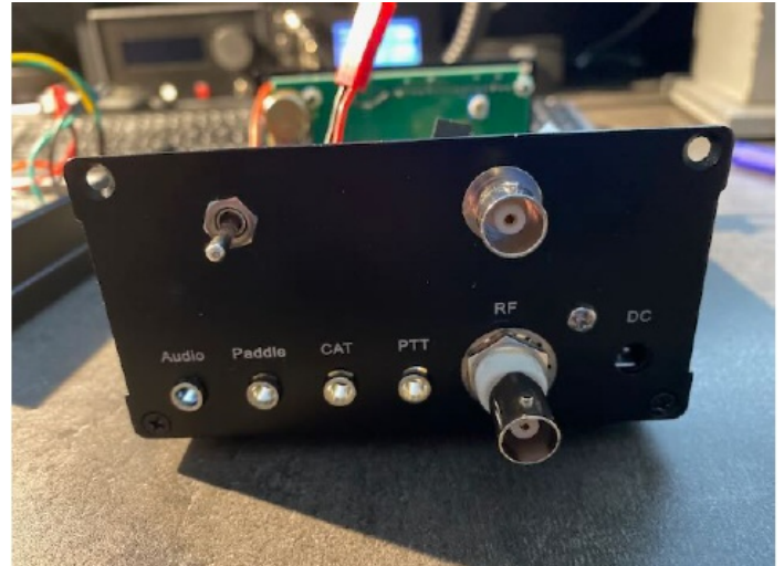
Extra schakelaar en BNC connector op de achterkant van de QCX
