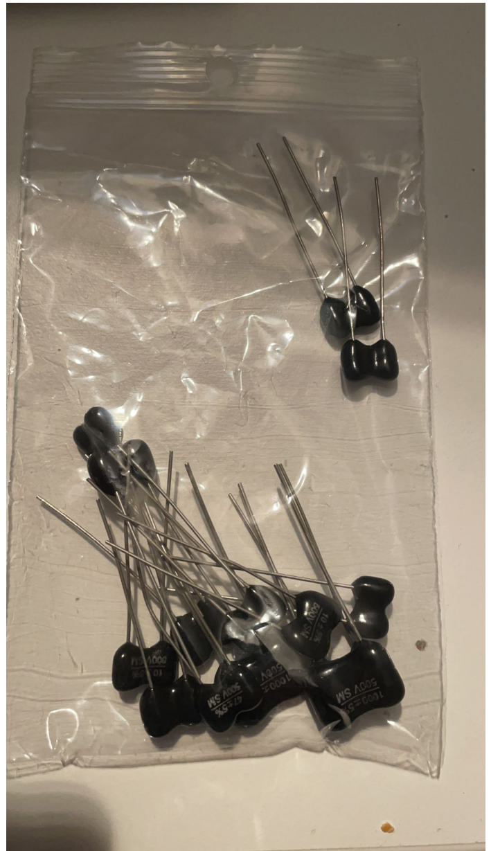
Mica condensatoren ter vervanging van de meegeleverde SMD's
