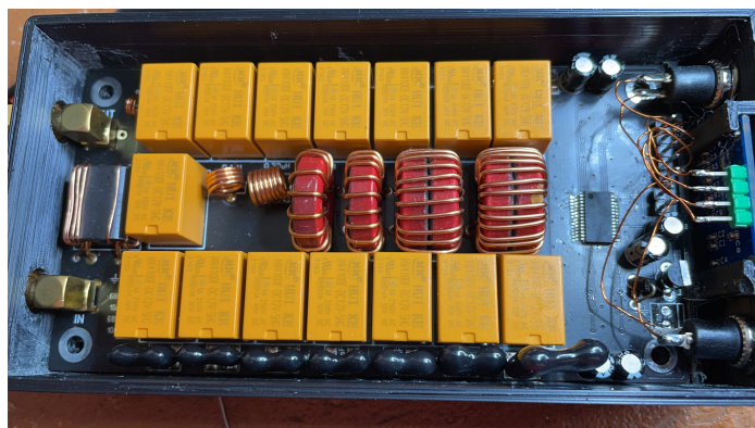
De tuner ingebouwd in het kastje
