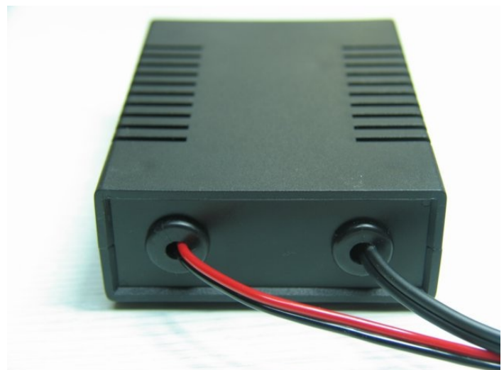
Achterzijde: draad naar de voeding en naar de microfooningang van de set.
