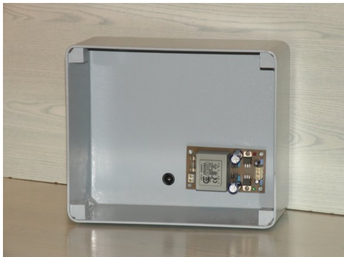
Figuur 42. Behuizing met gemonteerde voeding
