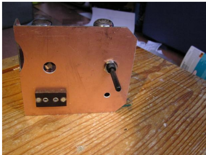
Vooraanzicht. Aan de rechterkant de volume potmeter en het gat voor de voedingskabel; aan de linkerkant het gat voor de asverlenger en de koptelefoon aansluiting.
