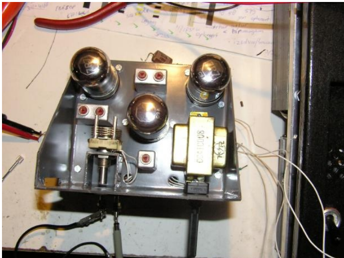
Bovenaanzicht. Let op de afstand tussen de MF trafo en de BFO condensator..
