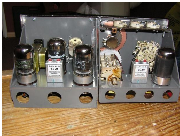
Subchassis gemonteerd. Let op de eerste spoel die aan de bovenste strip met trimmers is gemonteerd.
