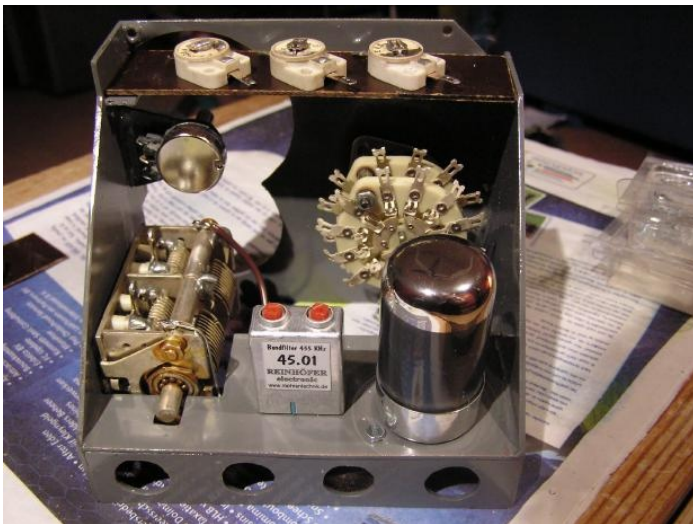
Chassis geschilderd, meer onderdelen geplaatst
