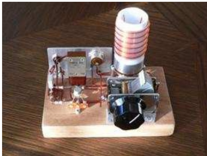
De zender. Frequentiebron lijkt een FT243 kristal.
