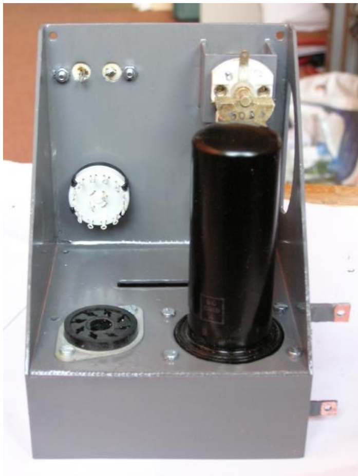
Achteraanzicht met de 6L6 geplaatst
