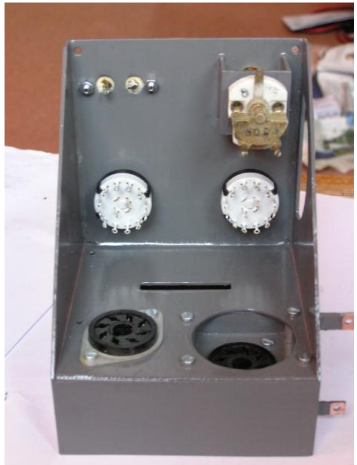
De front van het subchassis. De uitsnede linksonder is voor de doorvoer van de voedingskabel.
