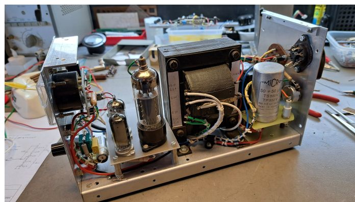
Opbouw van de voeding. Let op de modules die apart gemonteerd zijn
