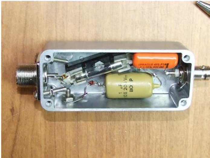
De onderdelen gemonteerd in het kastje
