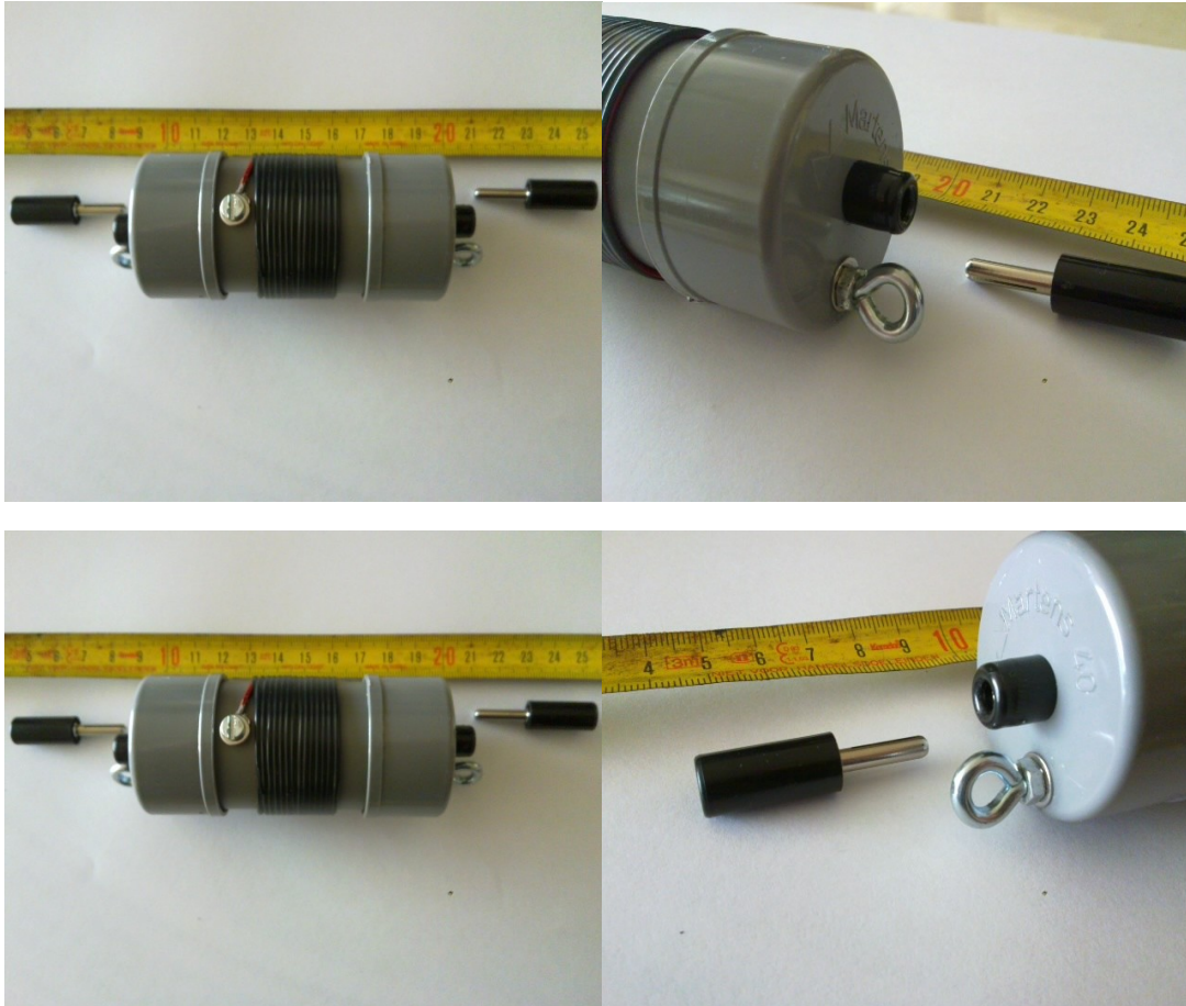
Spoel 1 ( 14.000 Mhz ) Die ik heb gemaakt voor deze Antenne
