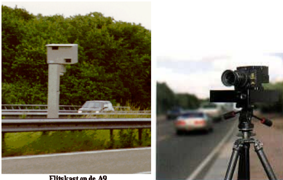
Figuur 24 Een flitskast met een Gatsometer (links) en een mobiel opgestelde Multanova radar (rechts).
