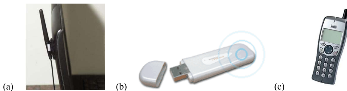
Figuur 16 Voorbeelden van WiFi applicaties: (a) een WiFi antenne aan een computerscherm, (b) een antenne voor de USB-poort en (c) een WiFifoon.
