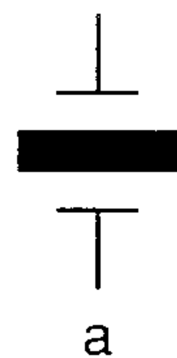
Figuur 10.7-1a Schema symbool van een kwartskristal
